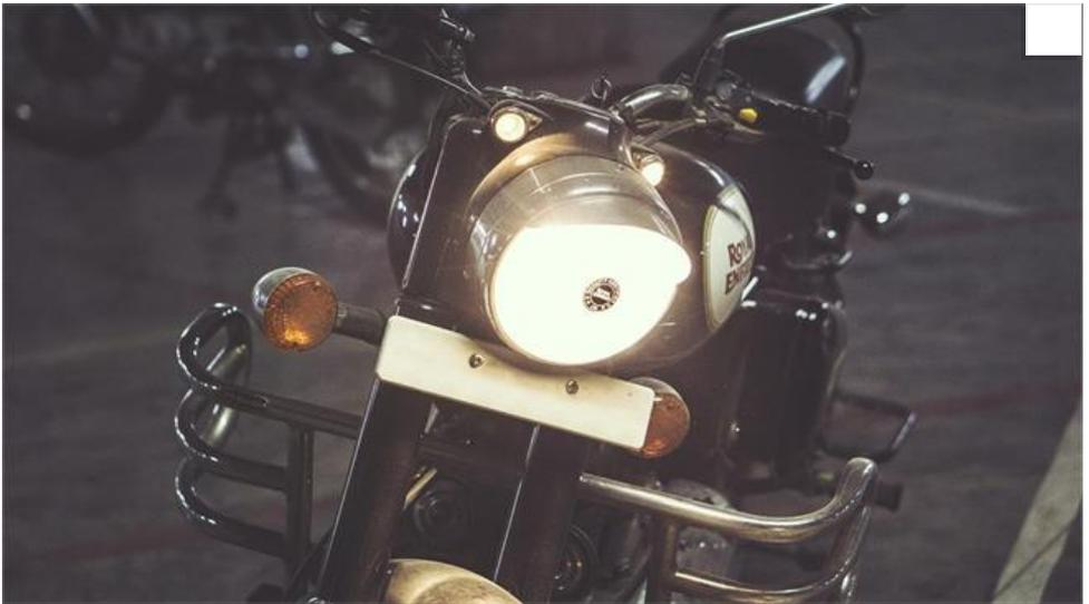
Las luces deben funcionar correctamente y los faros estar bien nivelados para que iluminen correctamente y no deslumbren a otros conductores.
