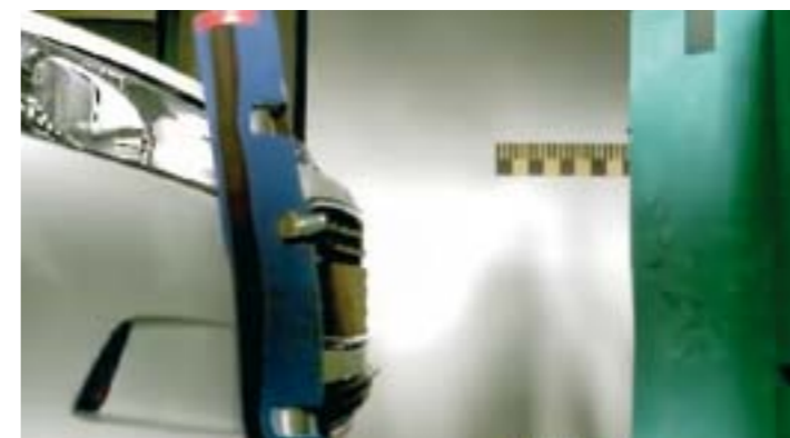
Para analizar la protección a los peatones se hacen dos 'crash test': uno contra un poste -arriba- y otro contra el parabrisas que simula el impacto de una cabeza
